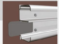
Os furos devem ser feitos a uma distância mínima de 50 mm da extremidade da base da canaleta, para não interferir na Tala.
