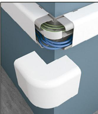
Para o perfeito encaixe da Curva Horizontal Externa, as Tampas das Canaletas devem ficar à 40mm de distância do fim da parede.
