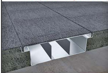
Detalhe de revestimento com Carpete em Rolo
