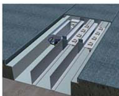
Detalhe dos suportes na calha 3 vias.
