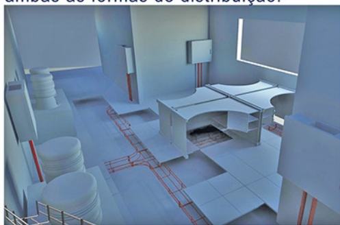
Distribuição com Leito Aramado
